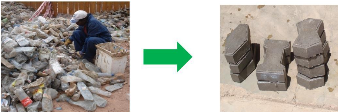
Fig. 84. Fabrication de pavés autobloquants au moyen de plastiques en mélange
