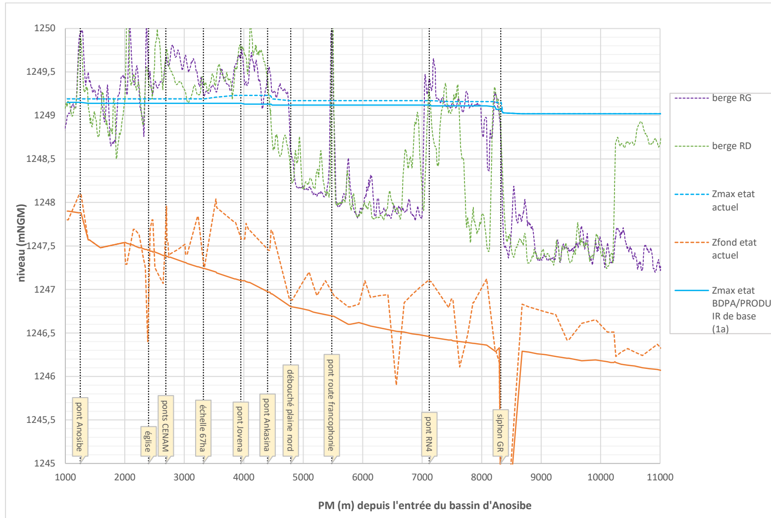
Fig. 83. Comparatif des lignes d'eau calculées dans le canal C3 pour l'évènement 50 ans en état réhabilité BDPA de base (1a) et actuel avec une capacité de pompage à Ambodimita de 9 m 3 /s contraint
